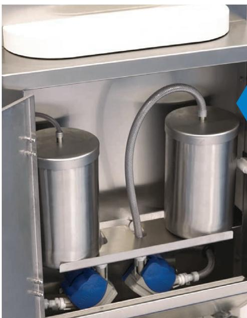
**Optionnelle Soft Serve Core\*** (pour modèles Super Tre AV EVO). Système de pompe péristaltique pour injecter le sirop directement à l'intérieur de la glace pendant l'octroi. Le cabinet pour l'emplacement du sirop est intégré sous la machine, totalement amovible pour un nettoyage intégral.
