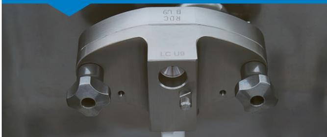
**Gravité - Version G.** Les différents diamètres des trous sur l'aiguille d'alimentation mesurent naturellement le mélange avec l'air ; pour une glace sec et compact avec un overrun jusqu'à 40%. Le curseur de réglage de l'aiguille permet, grâce au trous multiples sur la partie inférieure et supérieure de l'aiguille, le réglage de l'overrun aussi avec cuve pleine.
